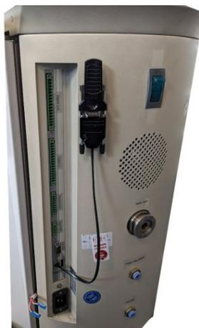
⇒ BT适配器及IFCBT-Dongle已固定并连接在UL1000 / UL5000上。
