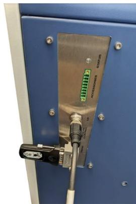
**2** 将IFCBT-Dongle定位在转角适配器上，然后在转角适配器的固定螺母上拧上IFCBT-Dongle的固定螺栓。
