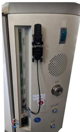
⇒ Adattatore BT con IFCBT-Dongle fissato e collegato all'UL1000/UL5000.
