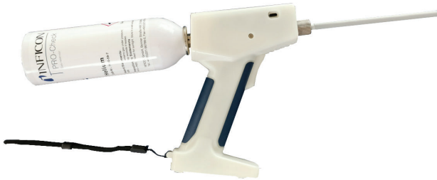
Fig. 1: SMART-Spray avec cartouche d'hélium
