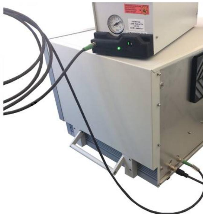
Fig. 1: CalMate raccordé au raccordement « TL » du détecteur de fuite à renifleur XL3000flex
