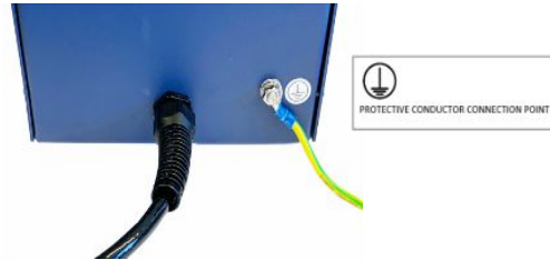
Fig. 1: Le câble de mise à la terre (ici jaune-vert) doit être fixé à la connexion du conducteur de protection du boîtier d'interface en utilisant la rondelle et l'écrou prémontés !
