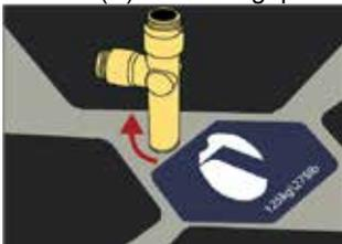
3. Ein Ende des Kaltemittelschlauchs (C) an das T-Stuck (A) und das andere Ende an den Kugelhahn (B) anschlieen.
