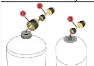
5. Bei geschlossenem Kugelhahn (B) Kaltemittelflaschenadapter (E) an das T-Stuck (A) anschlieen.
