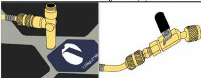
4. Passenden Adapter fur die Kaltemittelflasche auswahlen und an der Flasche befestigen.
