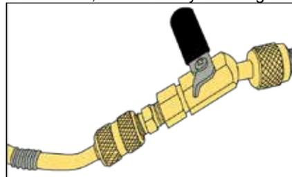
7. Kugelhahn (B) langsam offnen, um das System zu fullen. Nach Abschluss Hahn schlieen.
