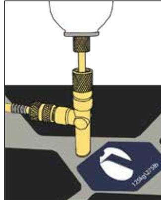
6. Kugelhahn (B) an das System anschlieen.
