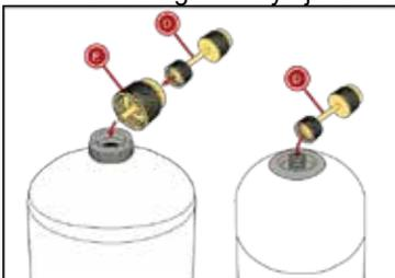
5. Con la válvula de bola (B) en posición cerrada, conecte el adaptador del depósito de refrigerante (E) al racor en T (A).
