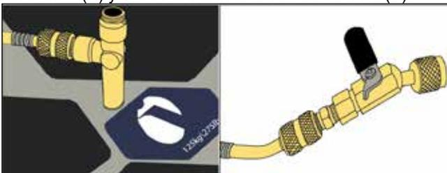
4. Seleccione el adaptador de depósito adecuado para su cilindro de refrigerante y fíjelo al cilindro.
