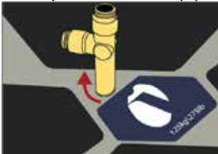
3. Conecte un extremo de la manguera de refrigerante (C) al racor en T (A) y el otro extremo a la válvula de bola (B).
