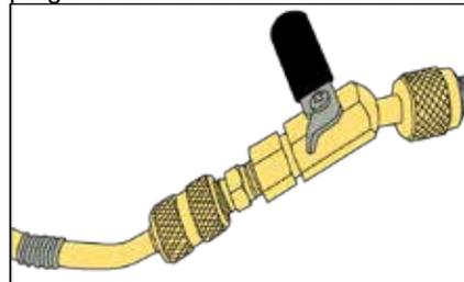
7. Abra lentamente la válvula de bola (B) de vuelta para cargar el sistema. Cierre la válvula cuando haya terminado.
