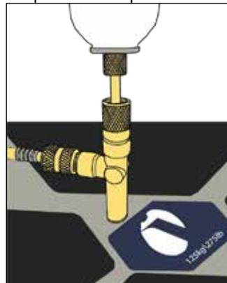
6. Acople la válvula de bola (B) al sistema.
