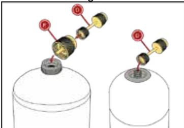
5. Après avoir mis la vanne à bille (B) en position fermée, reliez l'adaptateur de réservoir de réfrigérant (E) au raccord en T (A).
