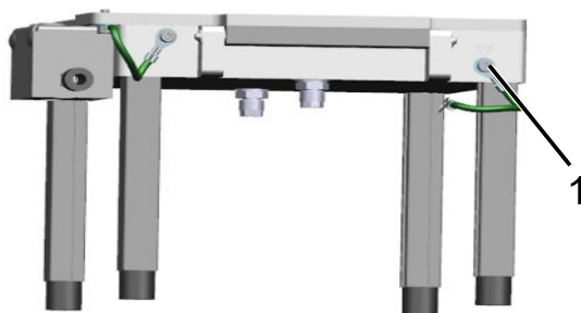
1 テストチャンバー背面の電位平衡接続部
