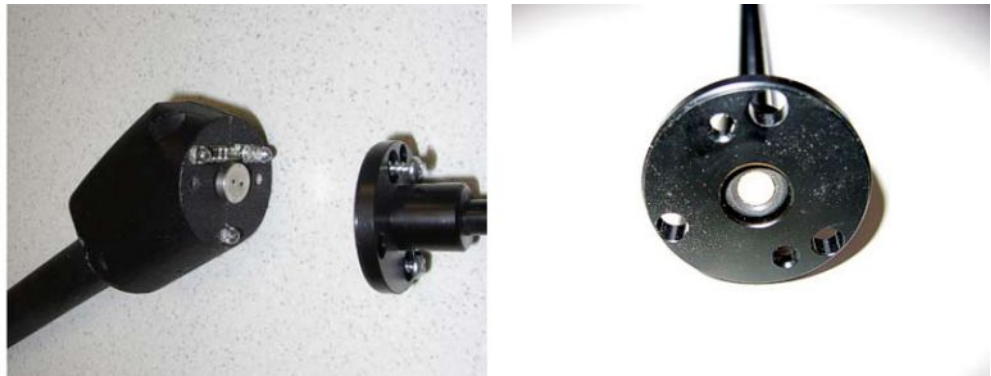
Fig. 19: Filtre Sinter dans la poignée de renifleur
