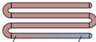
Figura 2: Distribución del gas sin evacuación previa
