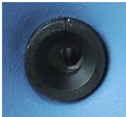
図 10: センターリングの取付け
