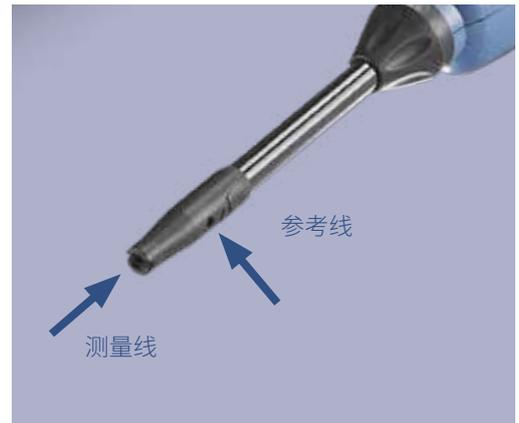
HLD6000可以配备针对待检测气体优化的吸枪探头。除了用于CO<sub>2</sub>和R600a/R290的吸枪探头外，还有一种通用的Smart吸枪探头，可用于卤素基冷媒。
