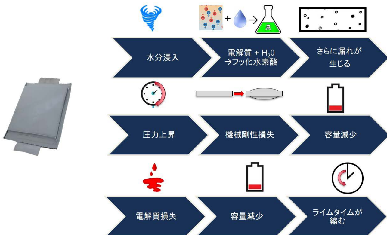
ソフトパウチセルの3つの不具合モデル
