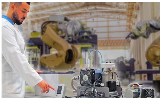
LDS3000 AQ リークディテクターを用いた アキュムレーションリークテスト
