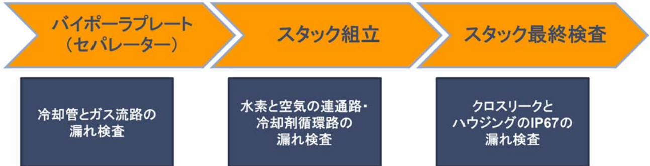
燃料電池スタックの生産時のテストステップ
