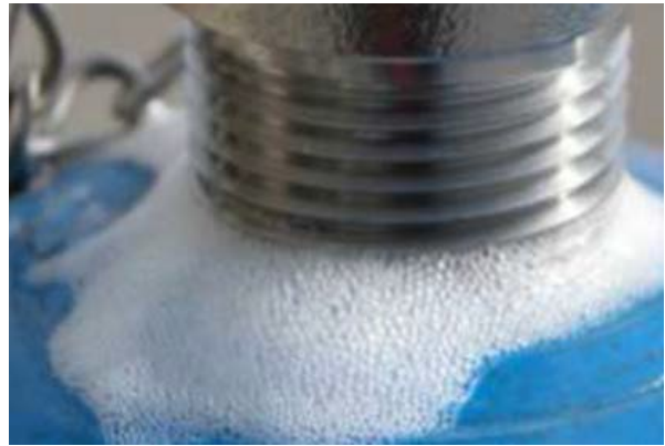
简易的步骤：螺纹连接处的肥皂泡测试
