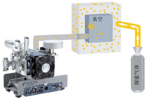
真空试漏(真空在试件中)尤其适用于生产线测试
