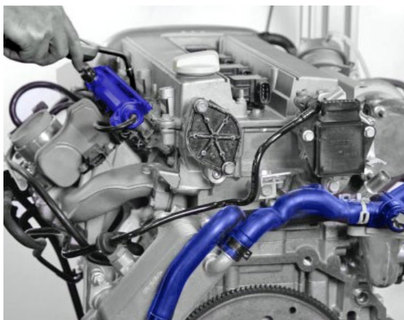
对于发动机, 采用探索气体的吸枪检漏比喷射检漏液更为清洁, 有效和更精确
