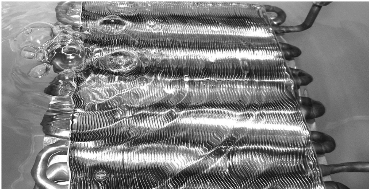
气泡测试的检测限值与试件的几何形状有关
