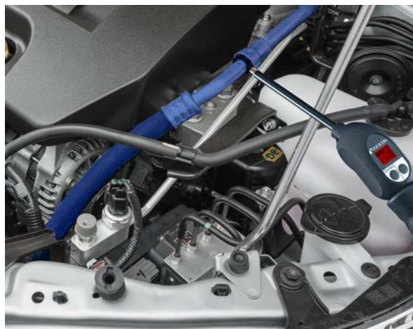
吸枪检漏用手动探头检测漏率高达 1 \times 10^{-7} 毫巴·升/秒
