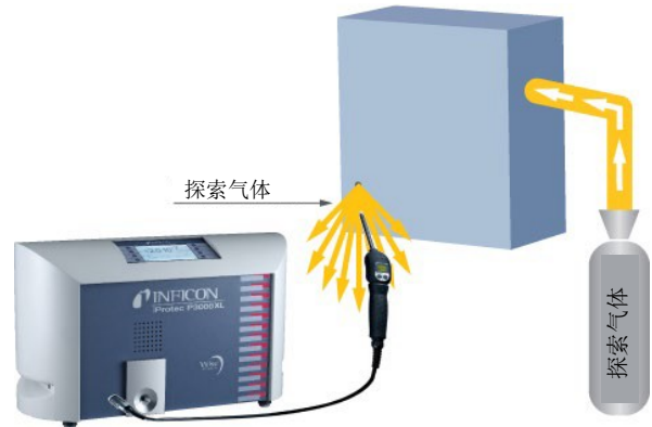
吸枪试漏 (用手动吸枪探头) 寻找确切的漏孔位置
