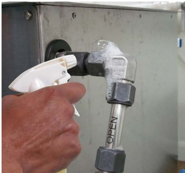
有泄漏的连接部位易于识别的气泡
