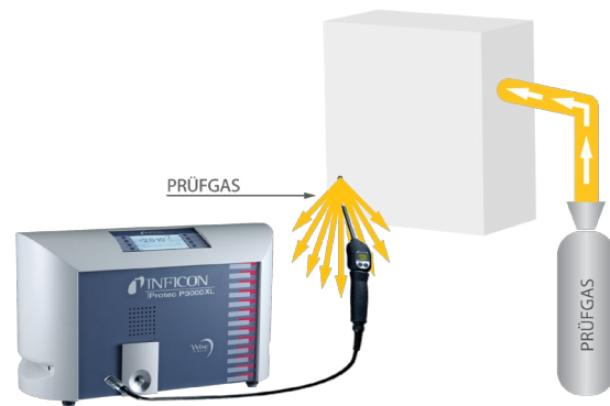
Schema der Schnüffellecksuche – mit einer manuellen Schnüffelspitze.
