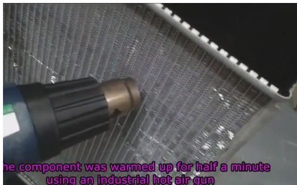
Dichtheitsprüfung an Verdampfern für Autoklimaanlage mit T-Guard.
