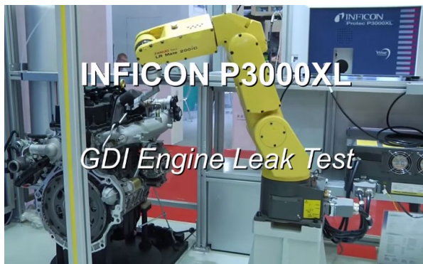
Roboterassistierte Dichtheitsprüfung an GDI-Motoren.
