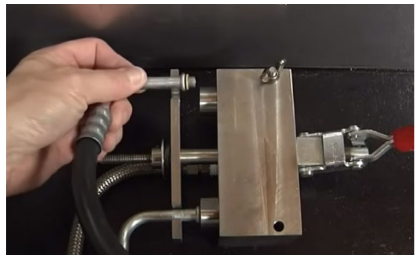
Dichtheitsprüfung an Klimaanlage schläuchen.
