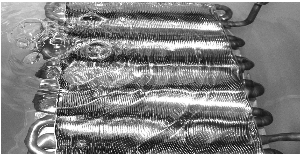
Blasenprüfung im Wasserbad.
