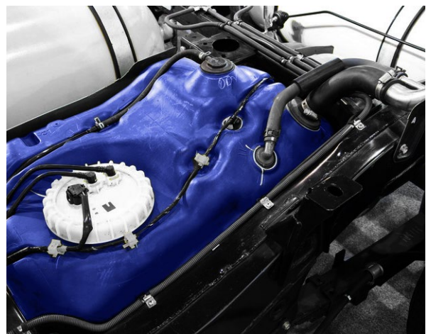
Kraftstofftank eines LKW.
