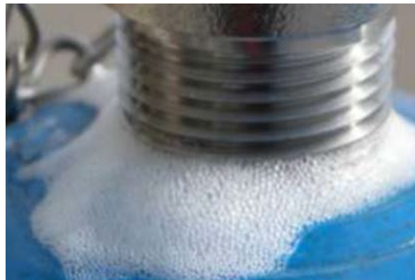
Schaumprüfung an einer Gewindeverbindung.
