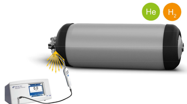
Schnüffellecksuche an den Armaturen eines Wasserstofftanks.
