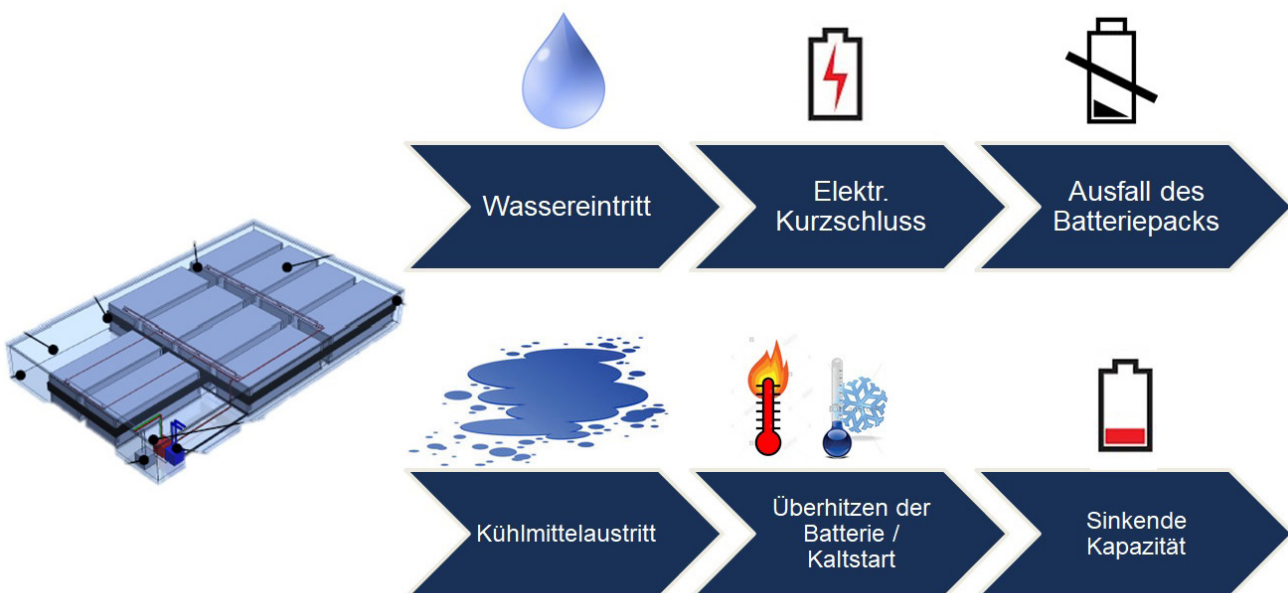
Zwei Versagensmechanismen bei Batteriepacks.
