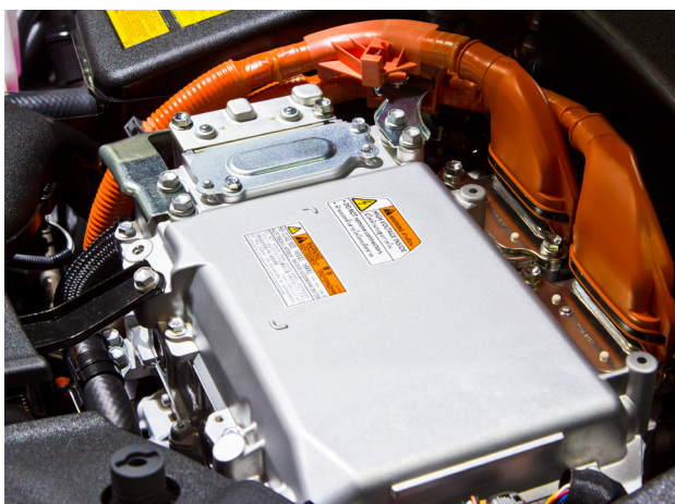
Lithium-Ionen-Batterie im Hybridfahrzeug.
