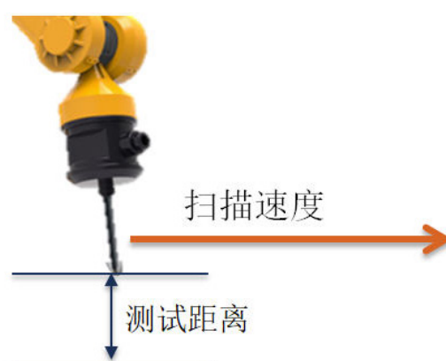
机器人吸枪检漏的两项限制因素。
