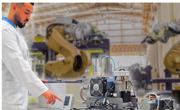
使用LDS3000 AQ检漏仪进行累积检漏
