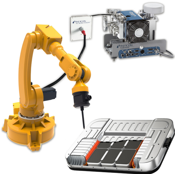
使用LDS3000模块化检漏仪以及XL吸枪适配器进行机器人吸枪检漏的示意图。
